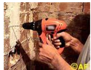
Taladro eléctrico de mano, que funciona con batería.
