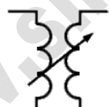
Transformador acoplamiento variable
