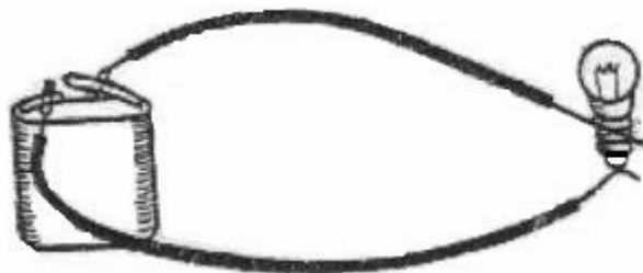
Figura 1. Circuito simple con una batería, dos pedazos de alambre conductor y una bombilla
